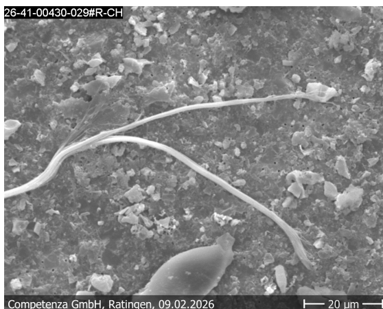
Abbildung und Elementspektrum: Chrysotil-Asbest Fundstelle 26-41-00430-029
